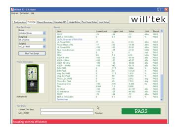
Las secuencias de prueba integradas soportan las tecnologías inalámbricas más populares: GSM, EDGE, WCDMA, HSDPA, AMPS, CDMA2000 y 1xEV-DO, y los parámetros predefinidos tales como los canales a comprobar y los factores de acoplamiento, permiten al operador iniciar las pruebas inmediatamente pudiendo también ser personalizadas con la aplicación Lector.
